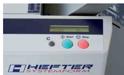
Un clavier d'opérateur clair avec un display LCD et un compteur à 4 chiffres
