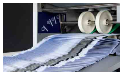
Grand plateau d'empilage télescopique pour au maximum 300 feuilles pliées
